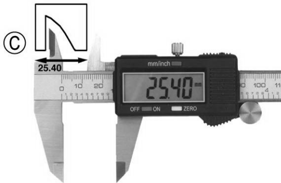
C. Pomiar powierzchni stopniowych
