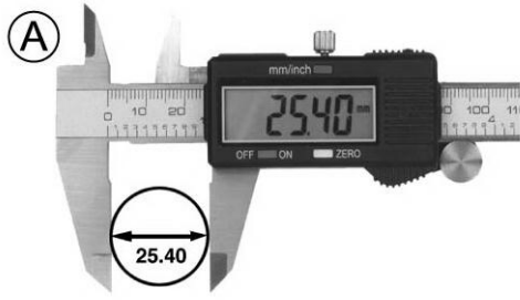
A. Pomiar powierzchni zewnętrznych
